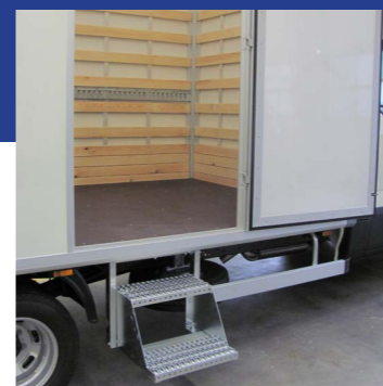
Kanteltrap onder de zijdeur
